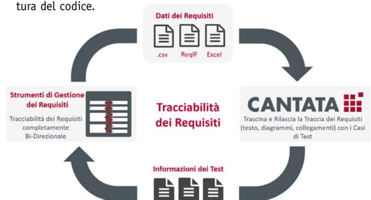
L'importazione / esportazione può avvenire tramite CSV, Microsoft Excel® o formato di interscambio di requisiti (ReqIF™), per adattarsi al flusso di lavoro e allo specifico strumento di gestione dei requisiti (ad es. IBM® Rational® DOORS®, PTC Integrity®, Polarion® REQUIREMENTS™, Intland codeBeamer®).
